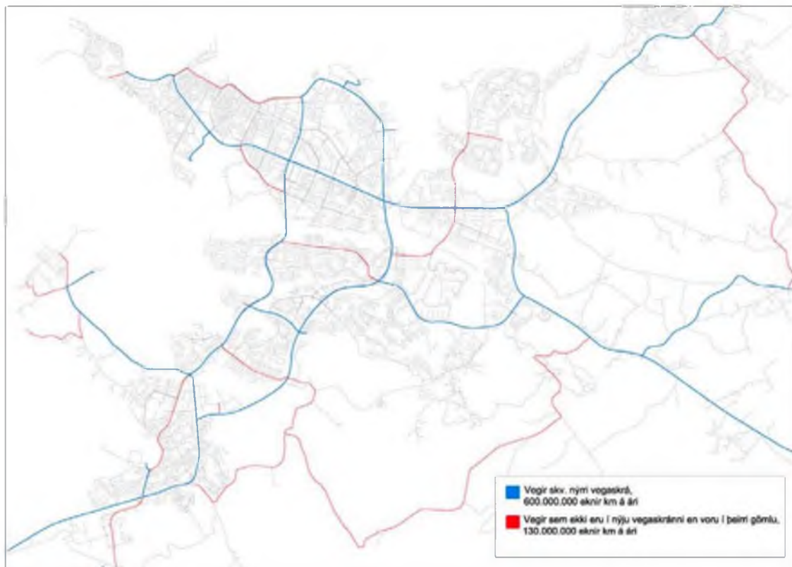
Mynd 1. Breytingar á þjóðvegaskrá milli áráanna 2007 og 2008. Myndin er ekki í kvarða (Þórarinn Hjaltason, 2009)
