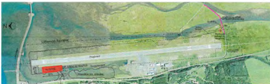
MYND 2 Yfirlitsmynd af Akureyrarflugvelli. Við vesturkant norðurenda flugbrautarinnar er fyllingarsvæði fyrir nýjan GP aðflugshallasendur. Syðst að austanverðu sjást fyrirhuguð mannvirki fyrir stefnuvita, loftnet og tengihús.
