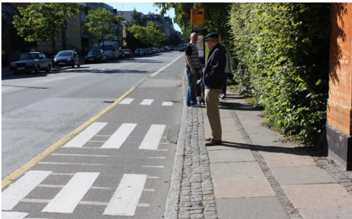
MYND 60 Strætóbiðstöð í Kaupmannahöfn. Strætófarþegar stíga beint út á hjólastíg, hjólreiðamenn víkja.
